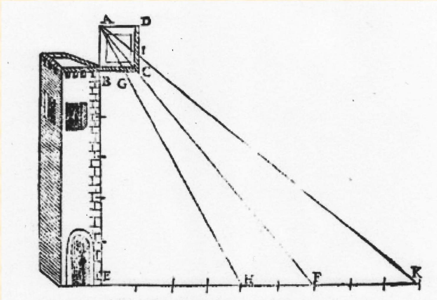
*“Come le linee rilevate ad angolo retto di sopra il piano del terreno si possono misurare”*
