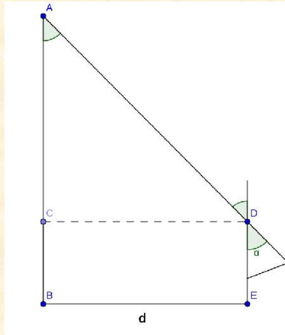
Se indichiamo con  $AB$  l'altezza del nostro edificio scolastico possiamo determinare con il triquetrum la corda dell'angolo e poi risaliamo all'angolo utilizzando la tavola delle corde.
