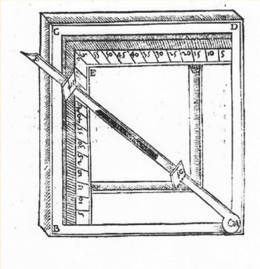
Lo strumento è costituito da quattro regoli di legno disposti secondo i lati di un quadrato.
